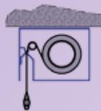
Anbau des Wickelgehäuses direkt an der Decke
